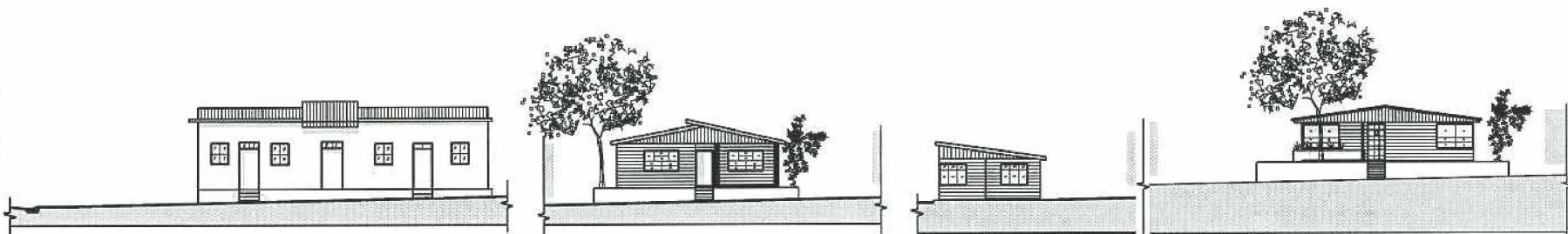
R2-14: Vivienda de madera con recubrimiento de lámina de zinc decorativo
